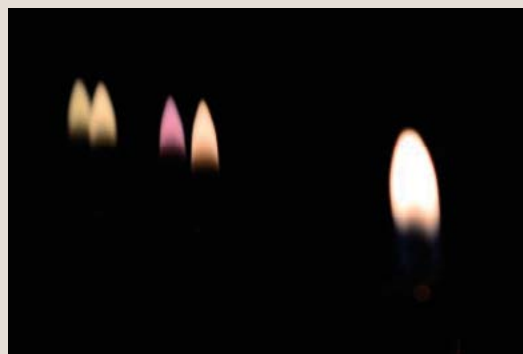
Low-E-Beschichtung (violette Flamme an der Innenscheibe)
