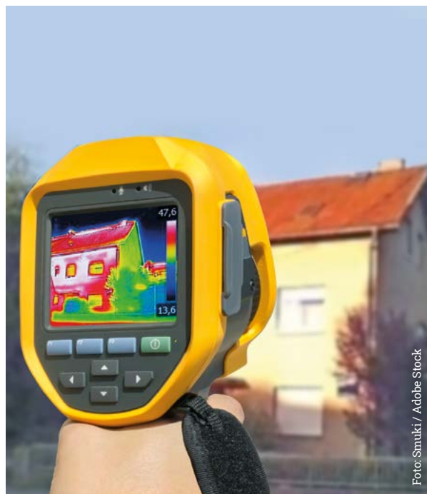
Thermografie eines Gebäudes, bei der die Bereiche mit dem größten Wärmeverlust hervorgehoben werden.
