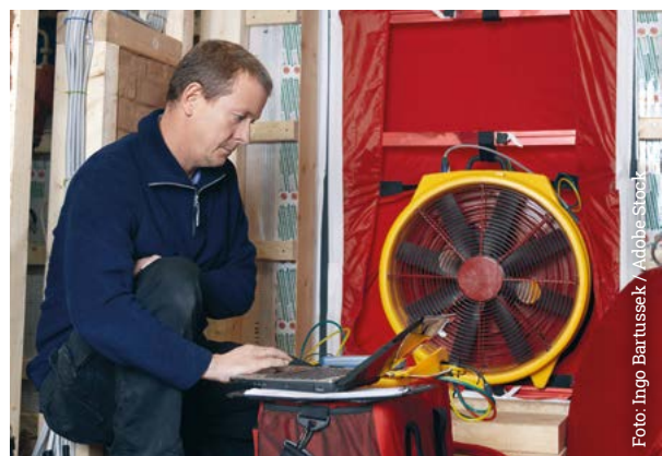
Blower-Door-Test zur Überprüfung der Luftdichtheit des Gebäudes.
